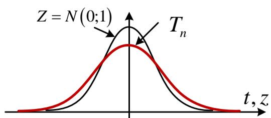
Рисунок 2.6 - Плотности  $z$ - и  $t$ -распределений
