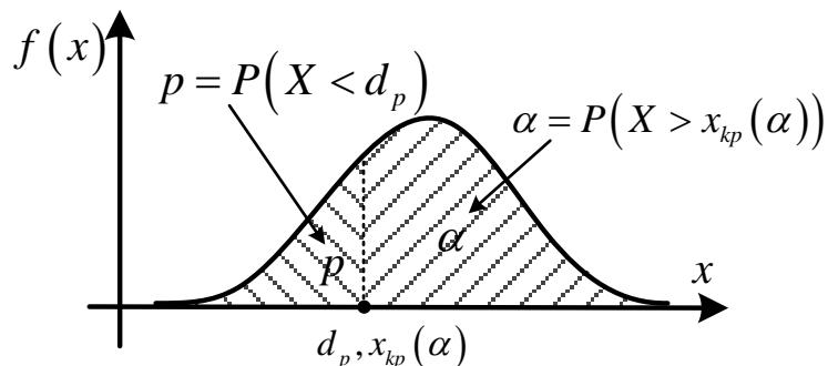
Рисунок 2.4 - К определению квантиля  $d_p$  и критической точки  $x_{kp}(\alpha)$  распределения (если  $d_p = x_{kp}(\alpha)$ , как на рисунке, то  $\alpha = 1 - p$ )
